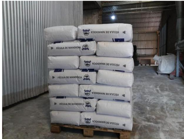
Completada la estiba se la envuelve de forma manual con plástico tipo film y se traslada con auto-elevador hasta el depósito.
