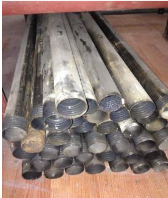
Figura N° 15: Barras de revestimiento. [Fuente: Elaboración propia, 2015].
