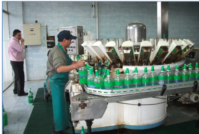
Figura N° 15. Llenado y carbonatación de sifones
