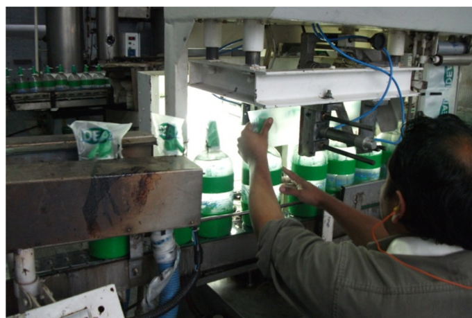
Figura N° 16. Termosellado de envases
