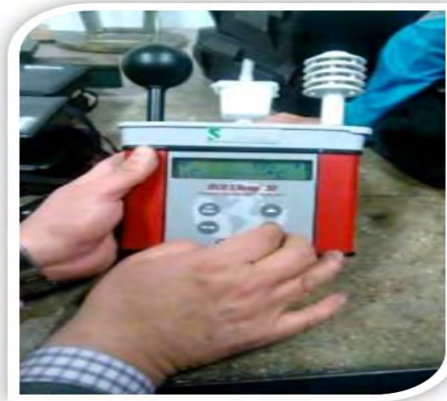
Figura 2.4. Equipo de medición de carga térmica
