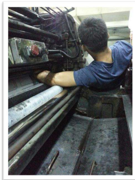
22 Riesgo de atrapamiento
