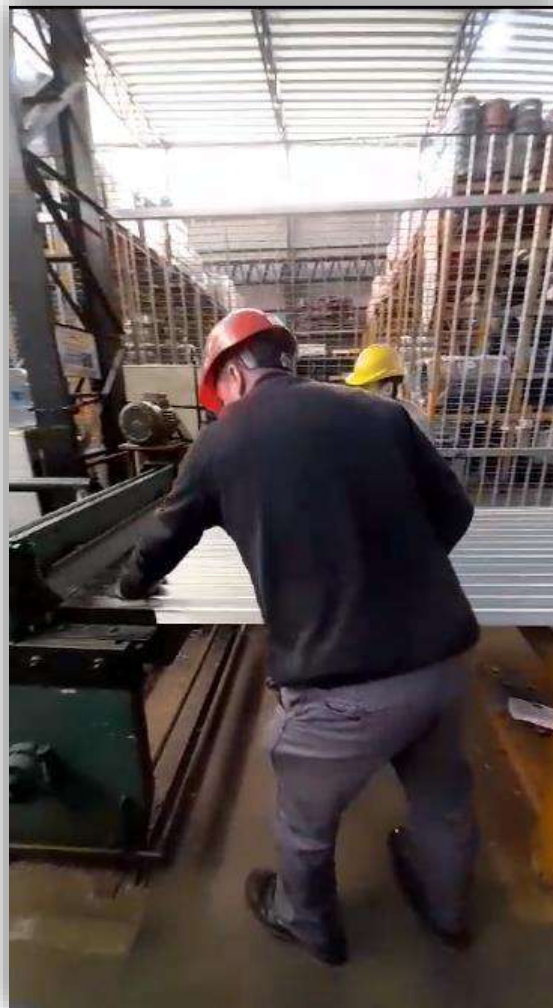
16 Operario colocando la chapa al nivel de corte
