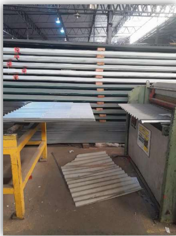
18 Cortes sobrantes en el piso
