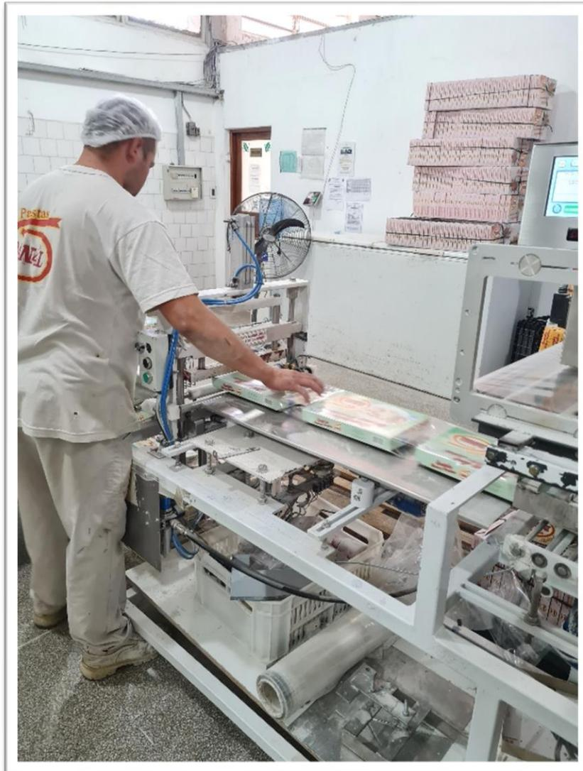
Siguiendo con el proceso el operario acciona la guillotina para ir conformando paquetes de 2 cajas de raviolos, los mismos se depositan en un carro para su posterior almacenamiento en la cámara de frío.
