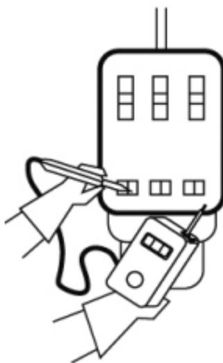
El funcionamiento de los detectores de tensión debe comprobarse antes y después de verificar ausencia de tensión con una fuente cercana
