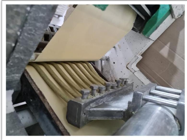
Funciona de forma automática y tiene capacidad para producir 10kg de ravioles en 10 minutos, esta cantidad representa 30 planchas estándar de ravioles. Debe ser alimentada con dos rollos de masa estirada hasta 3 mm y contiene un cilindro superior para la carga del relleno.
