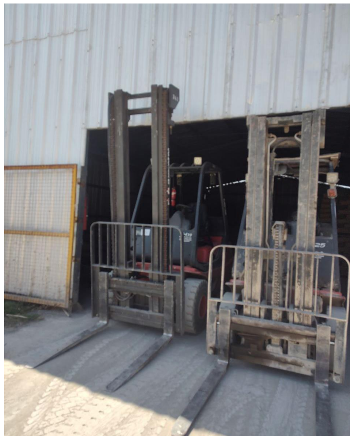
Fotografía N°3: Autoelevador Linde H30 – 3000 kg y Linde H25 – 2500 kg.
