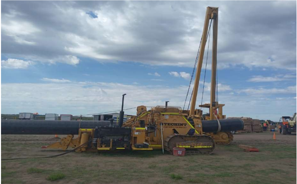
Curado, Puesta a punto de la Maquina de Curvado en el Obrador
