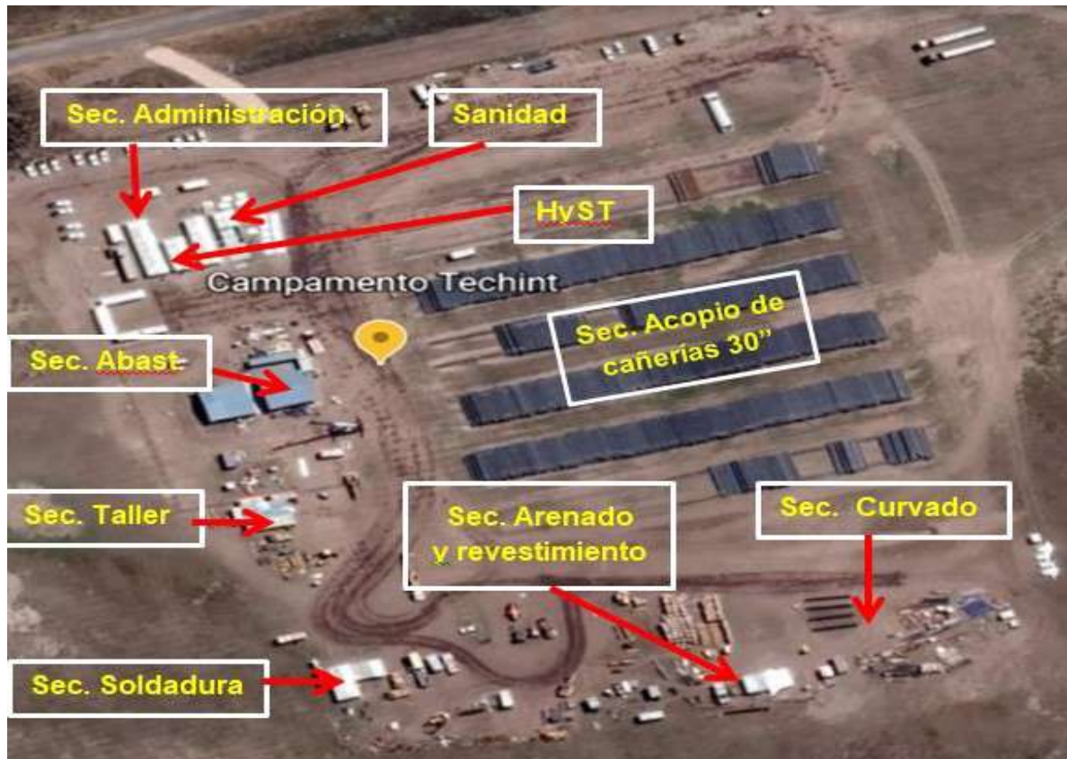
Delimitación de sectores de trabajo dentro del Campamento Base Naval Puerto Belgrano , Prov. de Buenos Aires
