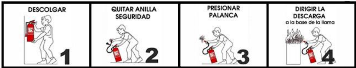
Ilustración 16 Uso correcto de extintores
