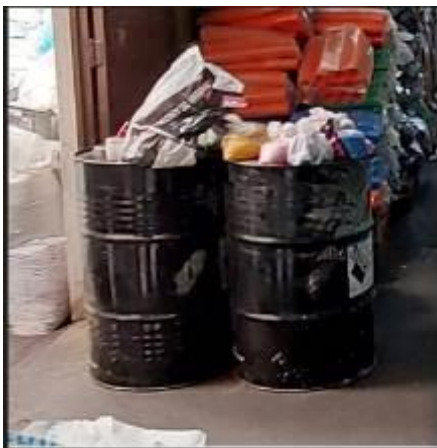
Foto 24 Aceite hidráulico cerca de materiales.
