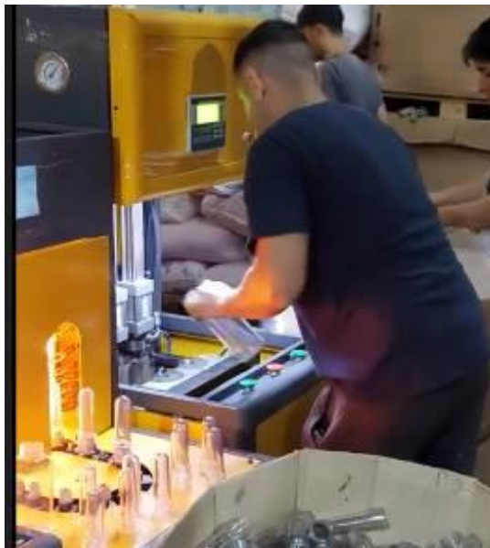
Foto 12 Sopladora PET semiautomática
