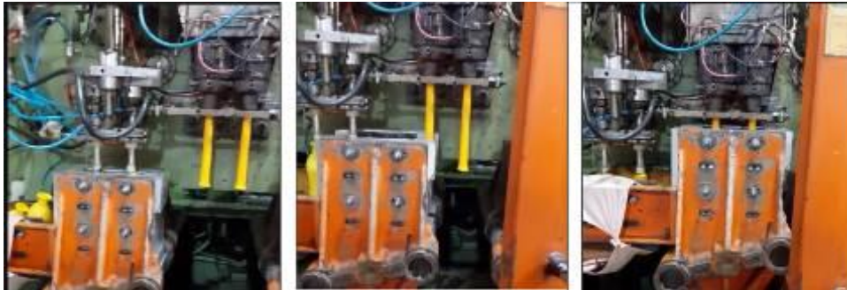
Foto 9 Generación de las mangas de plástico e inyección de aire.
