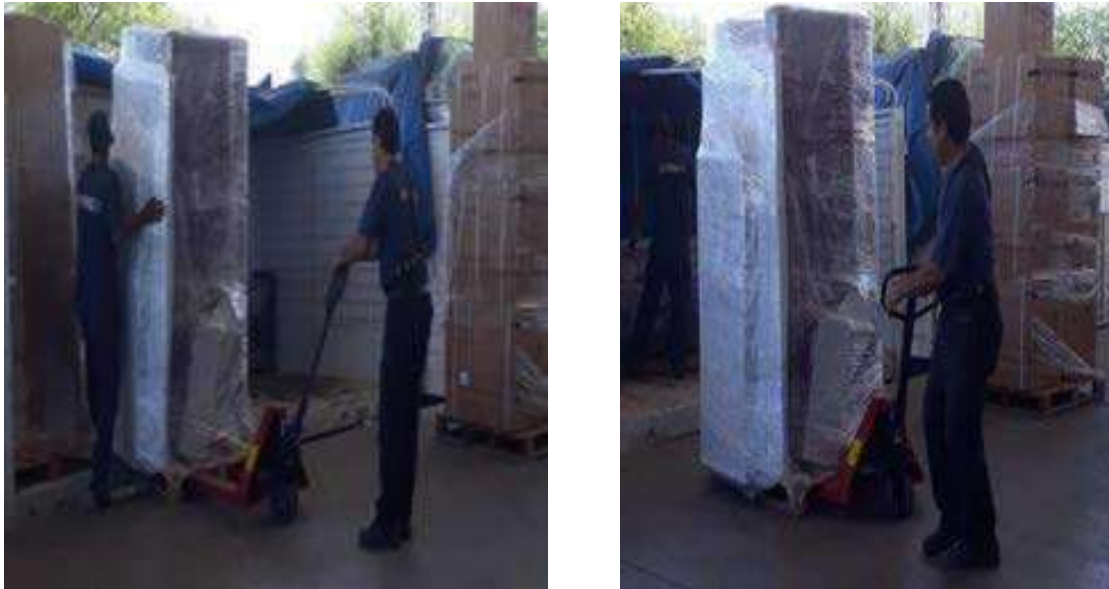
Imagen 33. Carga de la zorra Hidráulica o Patín Hidráulico
