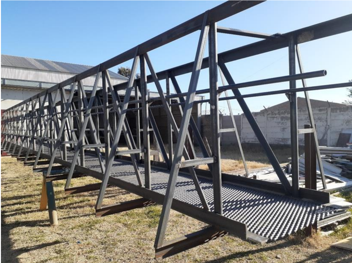
IMAGEN 3: PIEZA LUEGO DEL PROCESO DE ARENADO
