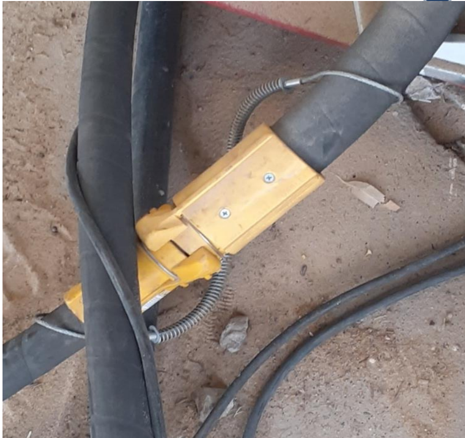
IMAGEN 5: SEGURO PARA EVITAR IMPACTO POR DESCONEXIÓN ACCIDENTAL
