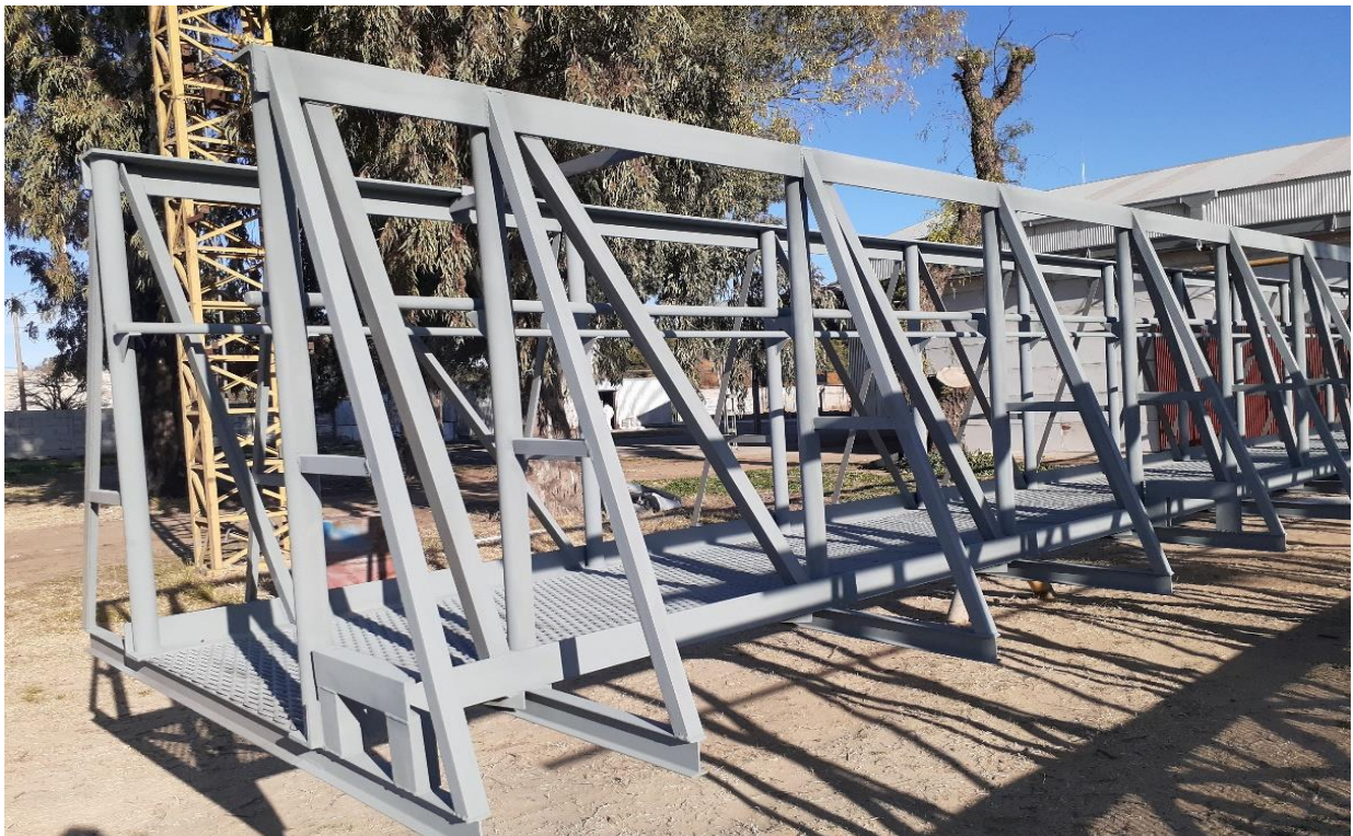
IMAGEN 2: PIEZA PREVIO AL PROCESO DE ARENADO
