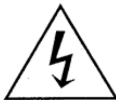
IMAGEN 16: SÍMBOLO DE "RIESGO ELÉCTRICO" ESTABLECIDO POR NORMA IRAM
