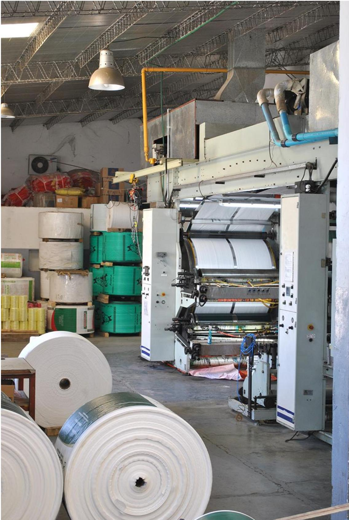
\*Vista en detalle de impresora flexográfica\*
