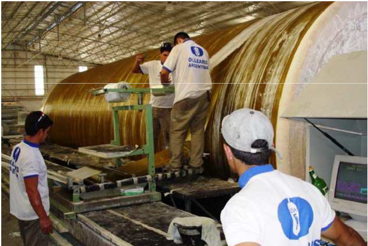
Figura 2.8 - Refuerzo mecánico con filament winding
