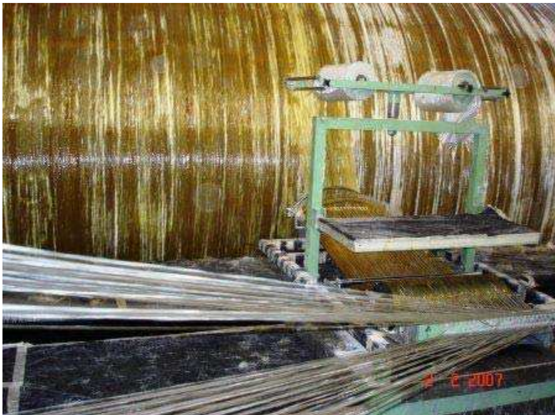
Figura 2.2 - Carro porta peine de máquina filament winding
