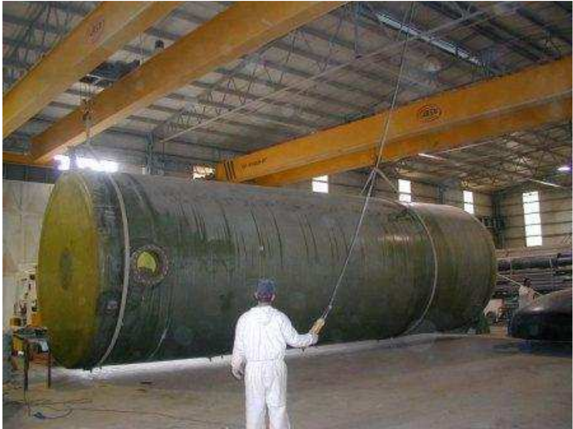
Figura 2.4 - Utilización de puentes grúas
