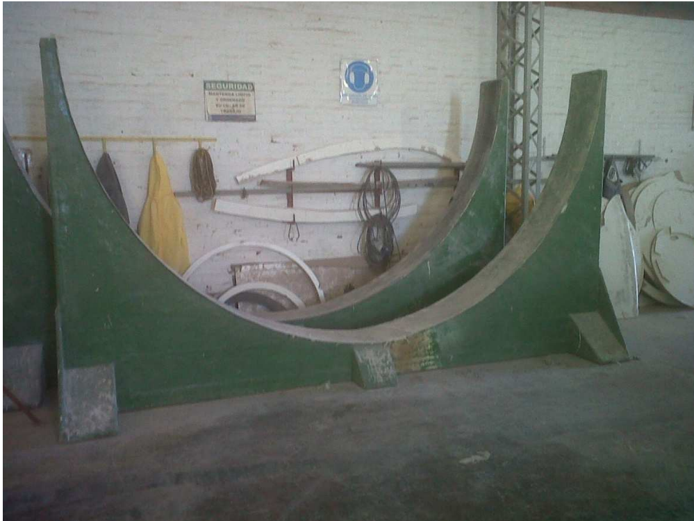
Figura 2.16 - Cunas de apoyo para moldes en el exterior
