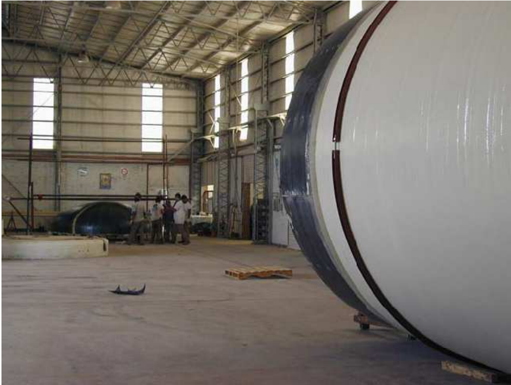
Figura 2.13 - Cilindro siendo desmoldado
