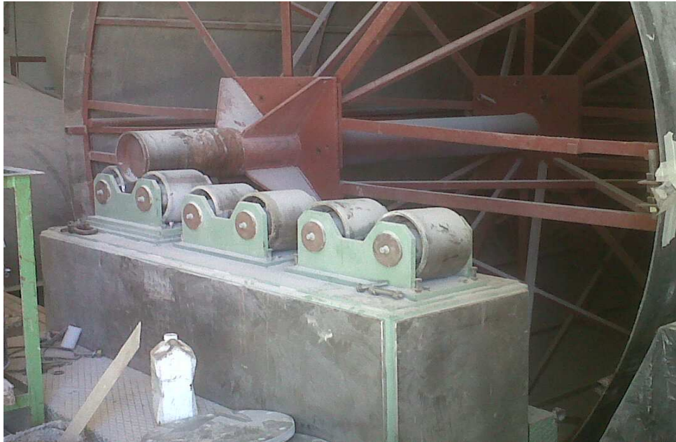
Figura 2.5 - Apoyo de eje del molde sobre rodamientos
