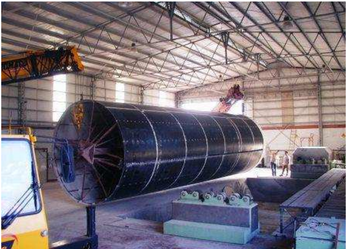
Figura 2.3 - Grúas posicionando moldes
