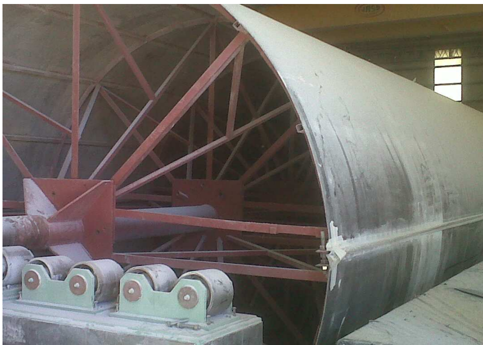
Figura 2.6 - Ajuste del molde mediante bulones
