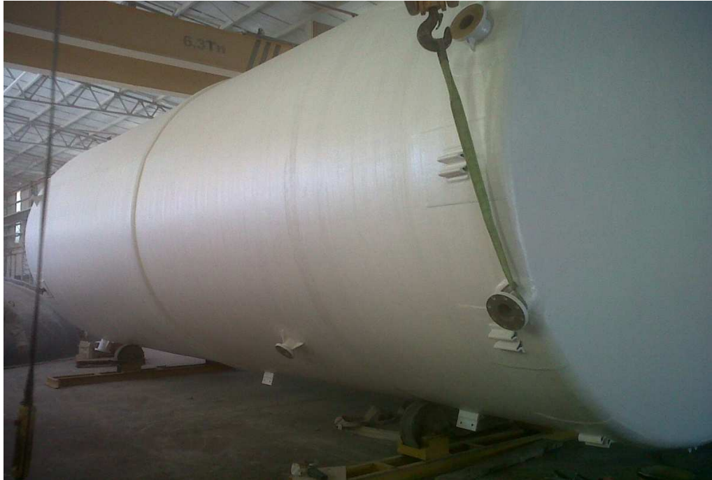
Figura 2.14 - Cilindro sobre cunas y eslingas para su rotación
