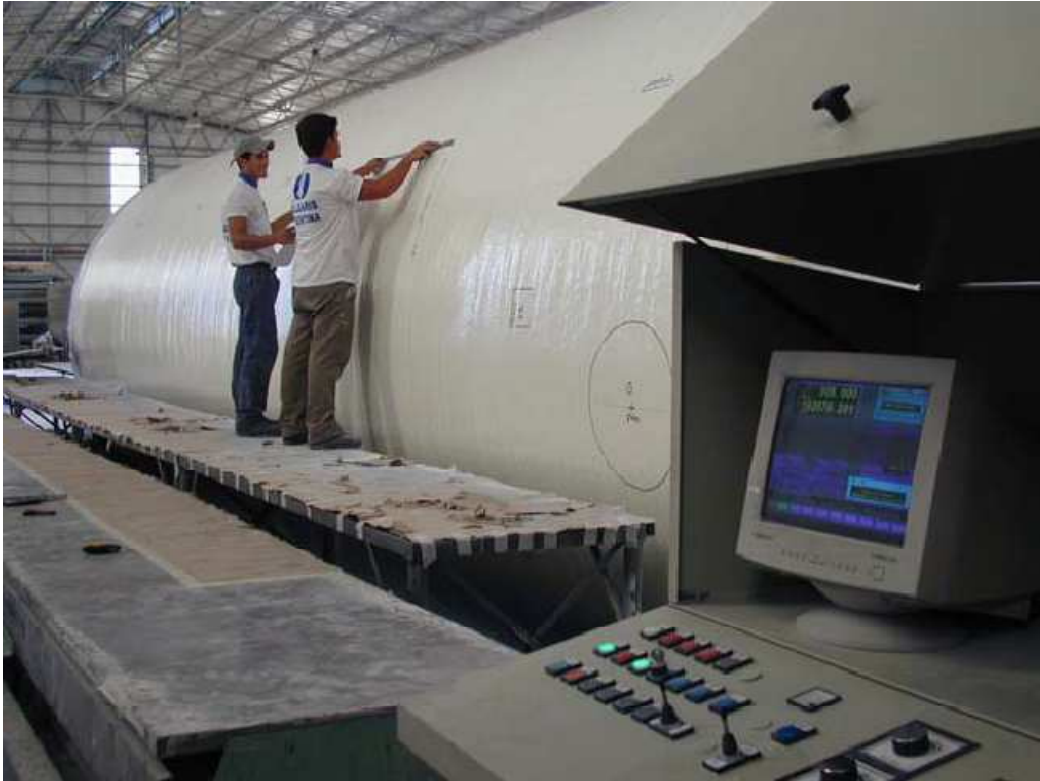
Figura 2.12 - Trabajo de trazado para cortes sobre el cilindro
