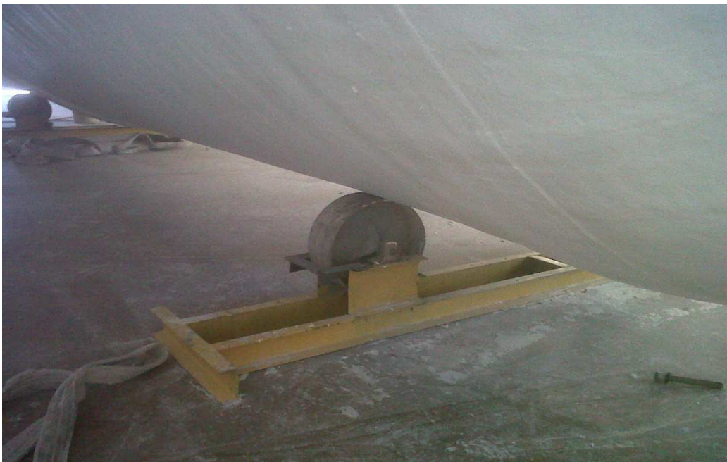
Figura 2.15 – Apoyo de cilindro sobre cunas
