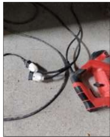
Prolongación sin doble aislación
