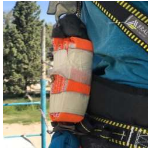
Cabo de vida retráctil dañado
