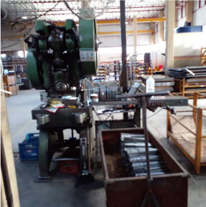
Figura 1.4 Balancín 60 t con alimentador de rollos de fleje.
