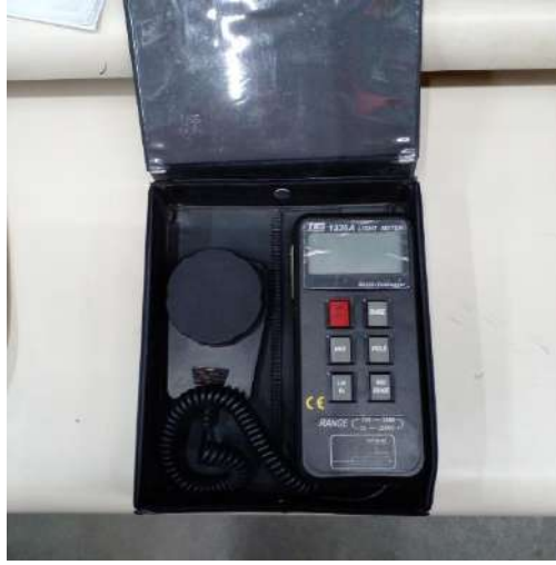
Imagen de Instrumento de medición Luxómetro TES 1336A
