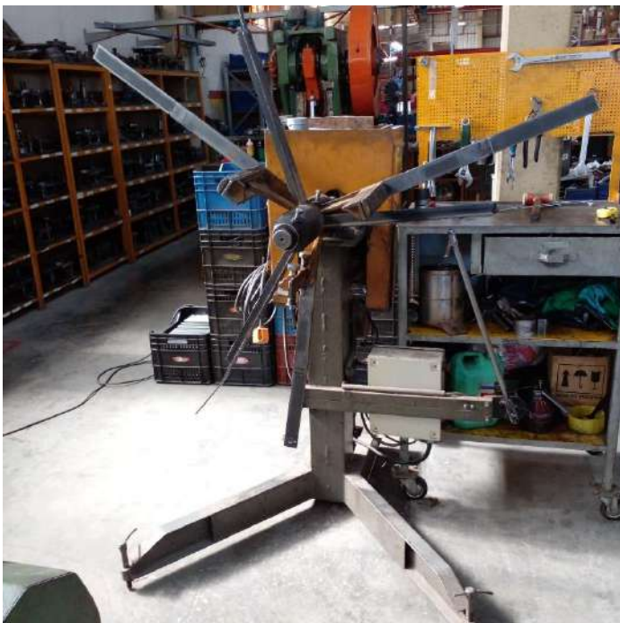
Figura 1.6 Alimentador de rollo de chapa Balancín 60 t.
