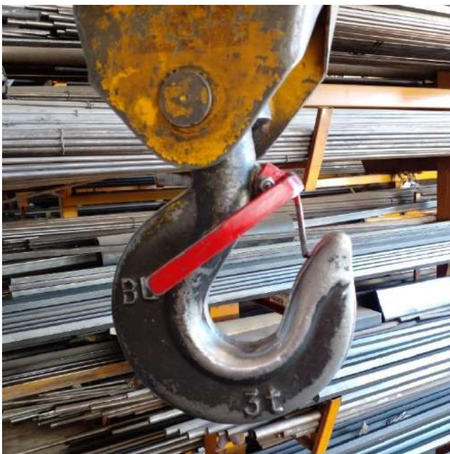
Figura 2.3.6 Gancho puente de grúa 1.
