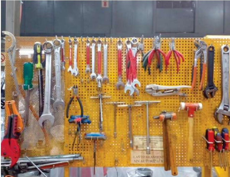
Figura 2.3.1 Tablero porta herramienta armado con las herramientas más usadas.
