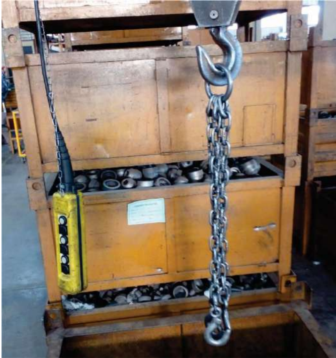
Figura 2.3.9 Gancho y control Puente de grúa 2.
