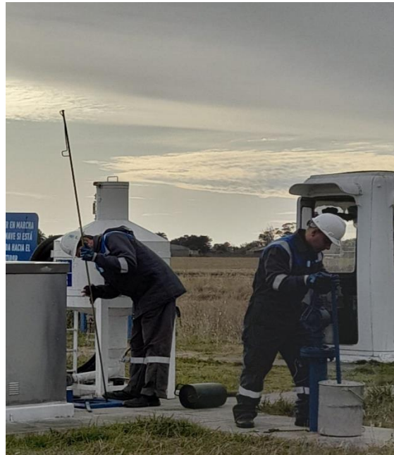
Foto: varillado de tanques
