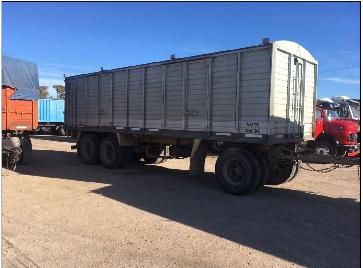
*Acoplado de 3 ejes con lona tipo destape.*
