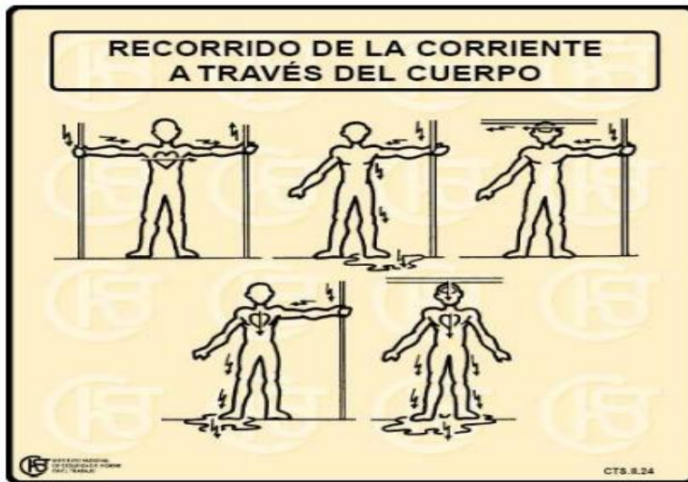
Recorrido de la corriente eléctrica.
