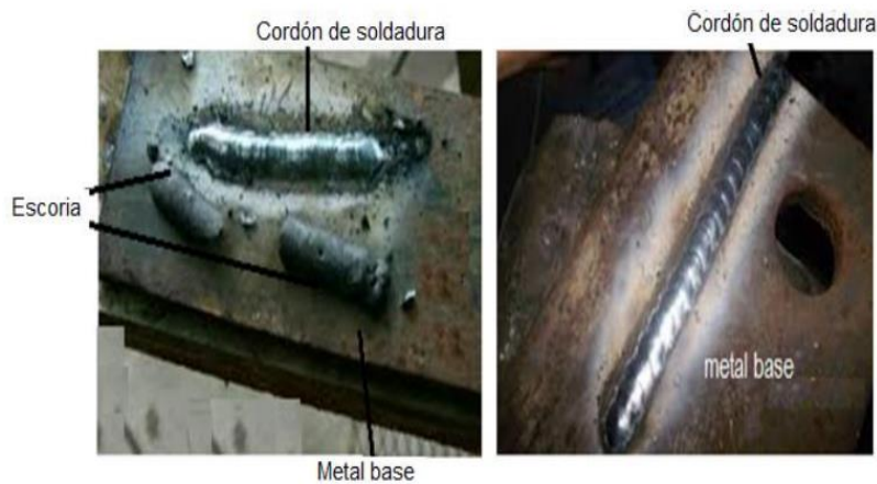
Cordón de soldadura por arco eléctrico.
