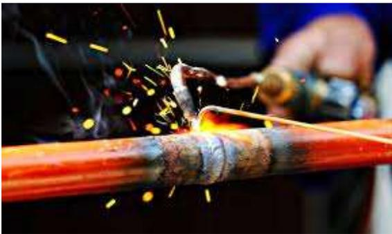
En el proceso de soldadura fuerte, siempre está la posibilidad de que se generen vapores y gases peligrosos por los recubrimientos del metal base, los mates de aportación que tienen zinc y cadmio, y el fluoruro de los fundentes.
