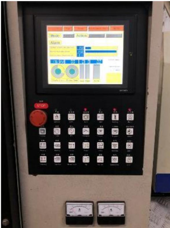
**Tablero de comando de inyecto sopladora.**
