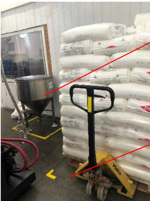
Se observa la tolva de carga de polietileno de la inyectora sopladora
