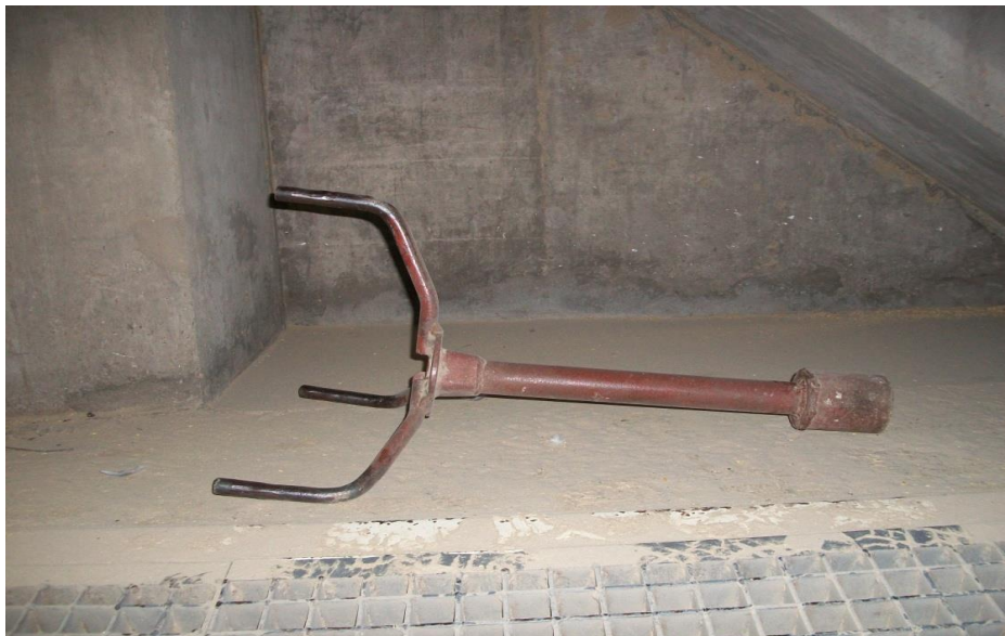
Figura 2.a. 2. Trípode utilizado para la apertura de vagones. (Bahia Blanca, 2012)
