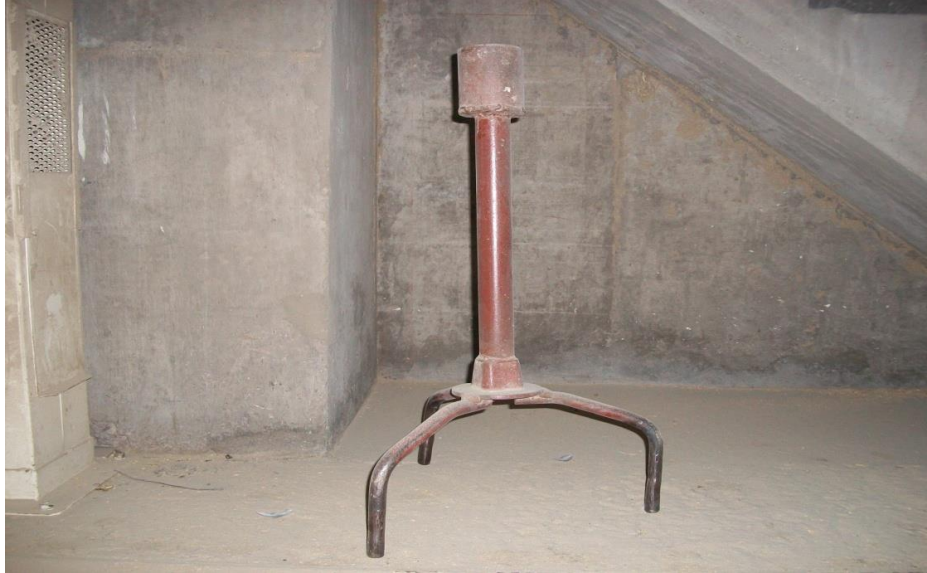
Figura 2.a. 1. Trípode utilizado para la apertura de vagones. (Bahia Blanca, 2012)
