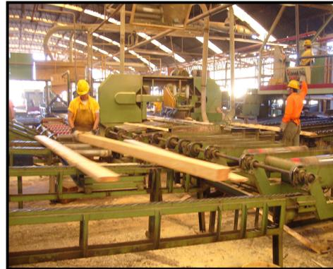
En la mesa de salida, dos operarios realizan la extracción manual de tablas costeros y los derivan a los centros en los cuales deben ser procesados. Se separan los costeros y se los deposita sobre la mesa de alimentación de la sierra "sin fin" horizontal de reaprovechamiento.
