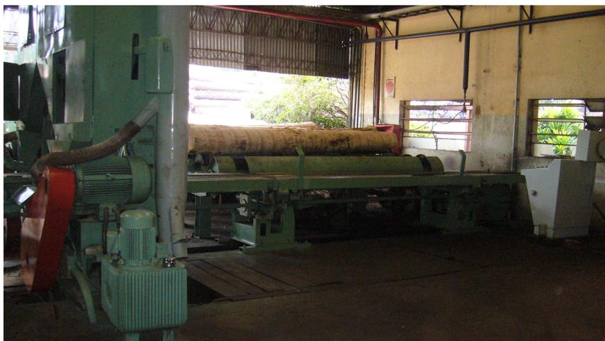
Se pudo observar en el sector de aserradero partes móviles correspondientes a las transmisiones mecánicas de las máquinas, las cuales no poseen protección correspondiente.
