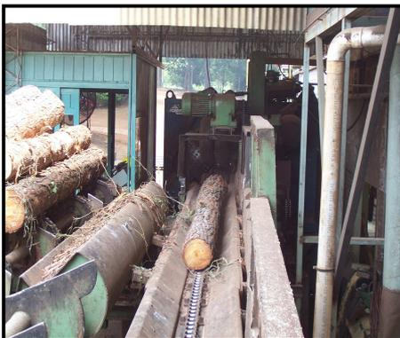
Una vez descortezado el rollo, se lo traslada a la mesa de alimentación de la sierra principal y se lo vuelca hacia la mesa por medio de un transfer de brazo.
