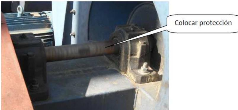
Se recomienda colocar dicha protección a las partes móviles del eje observado con el objetivo de evitar que se produzcan posibles atrapamientos por partes móviles.
