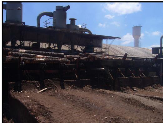
Abastecimiento Descortezadora: El operario de la descortezadora es quién deriva los rollos según sus diámetros a una u otra línea de alimentación.
