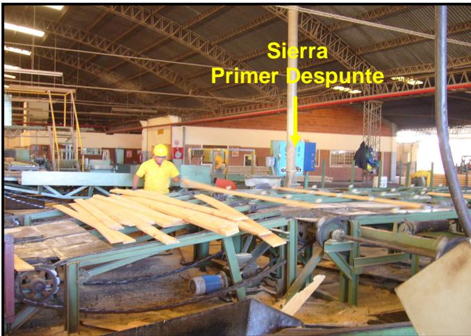
La operación se inicia cuando el operario ubica la tabla sobre el transporte que deriva la misma hacia la Sierra del Primer Despunte. luego esta tabla cambia de dirección por medio de unos rodillos desviadores, hasta que el extremo haya llegado al lateral opuesto de la mesa.
