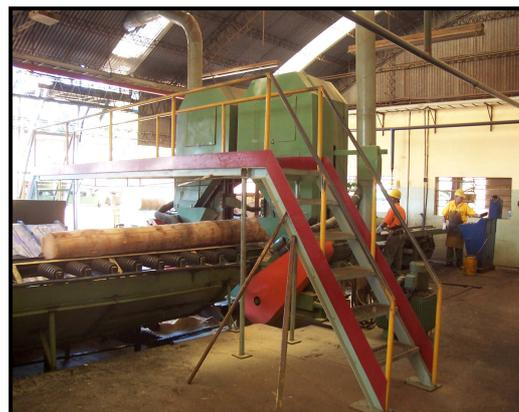
Dos operarios posicionan el rollo sobre la mesa de alimentación priorizando el aprovechamiento. Una vez en posición se acciona el sistema de transporte de alimentación que lo desplaza hacia el proceso del corte.
