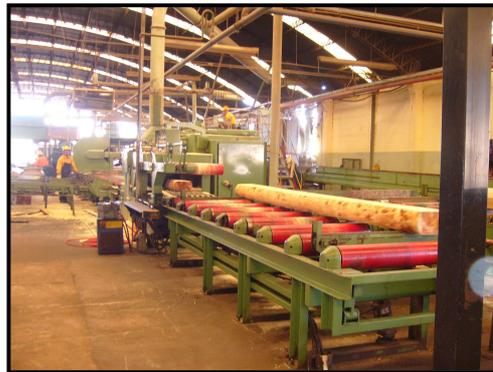
Se inicia con el traslado del bloque central del rollo desde la mesa de alimentación hacia el posicionamiento. Esta operación la realiza un operario desde un tablero de mando.
