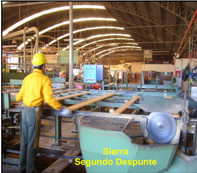
El segundo operario determina el largo de la tabla, utilizando una referencia respecto a la longitud de la misma, para luego despuntarla.
