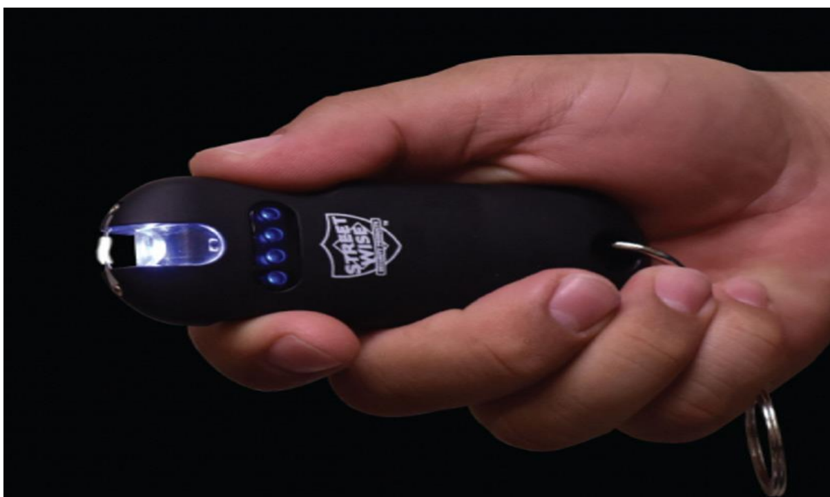
Ejemplo de una C.E.D. de tipo compacta, camuflada como un llavero-linterna, los dos electrodos en su parte delantera también cumplen la función de aturdir a una persona al ponerse en contacto. Imagen recuperada de: https://defenseshopper.com/smart-24-000-000-keychain-stun-gun/
