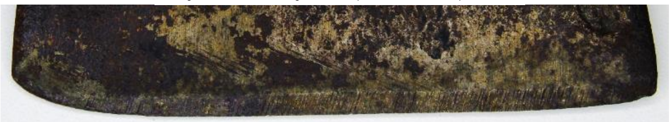
Fig. 29. Estriamiento en diagonal. Lado izquierdo del elemento de prueba A.
