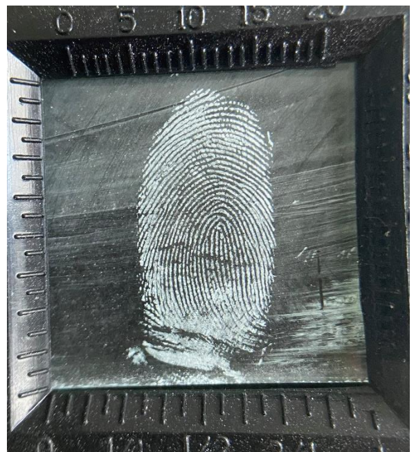
FIGURA 35: HUELLA DACTILAR ARTIFICIAL REVELADA CON POLVO PPR1 OBSERVADA BAJO LUPA CUENTAHILOS
