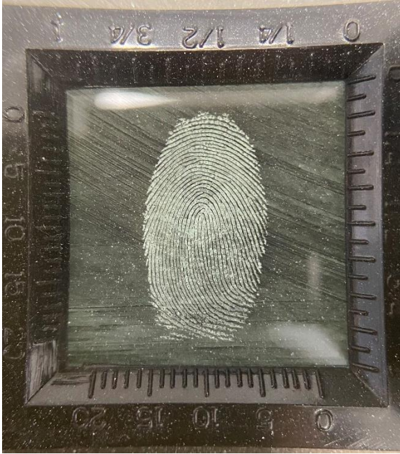
FIGURA 36: HUELLA DACTILAR ORIGINAL REVELADA CON POLVO PPR1 OBSERVADA BAJO LUPA CUENTAHILOS
