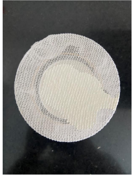
FIGURA 2: FILTRADO DEL LÁTEX
