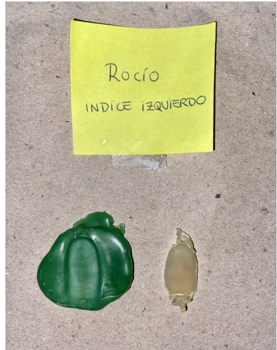
FIGURA 26: GUANTELETE EXTRAÍDO DEL MOLDE
