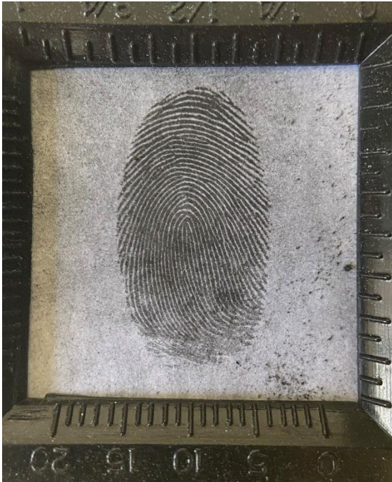
FIGURA 44: HUELLA DACTILAR ORIGINAL REVELADA CON POLVO MAGNÉTICO OBSERVADA BAJO LUPA CUENTAHILOS
