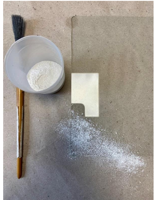
FIGURA 31: POLVO PPR1 USADO PARA EL REVELADO DE LAS HUELLAS SOBRE VIDRIO
