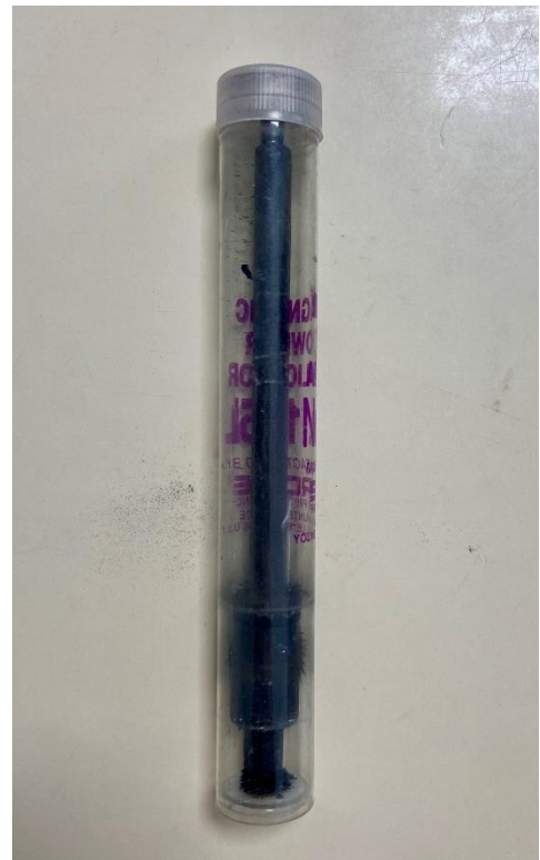
FIGURA 12: APLICADOR DE POLVO MAGNÉTICO
