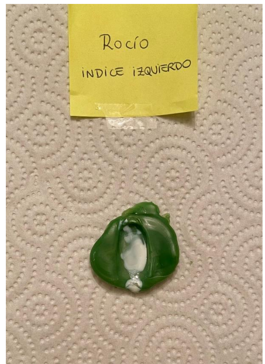
FIGURA 20: TERCERA CAPA DE LÁTEX SOBRE EL MOLDE
