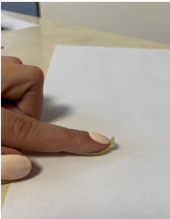
FIGURA 38: HUELLA DACTILAR ARTIFICIAL APOSENTADA SOBRE HOJA OFICIO
