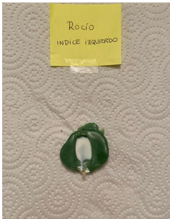
FIGURA 23: SEXTA CAPA DE LÁTEX SOBRE EL MOLDE
