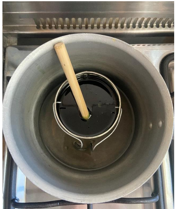
FIGURA 13 - 14: CALENTAMIENTO DE LA CERA PARA LA REALIZACIÓN DEL MOLDE
