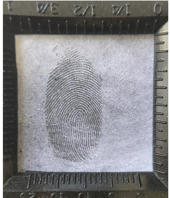
FIGURA 45: HUELLA DACTILAR ARTIFICIAL REVELADA CON POLVO MAGNÉTICO OBSERVADA BAJO LUPA CUENTAHILOS
