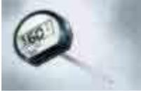
**>Digital:** Tampoco deben permanecer en el alimento durante la cocción. La punta del vástago deberá colocarse en el centro de la parte más gruesa del alimento y la temperatura se estabilizará en unos 10 segundos. Es muy apropiado para usar en alimentos de poco espesor.
