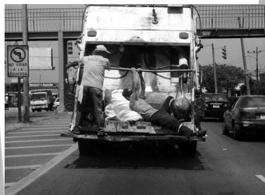
fig. 2.6: caída de recolector de residuos al subirse al estribo
