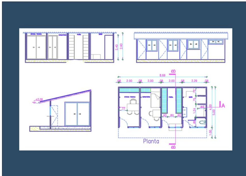
Figura N° 22 Plano del obrador.
