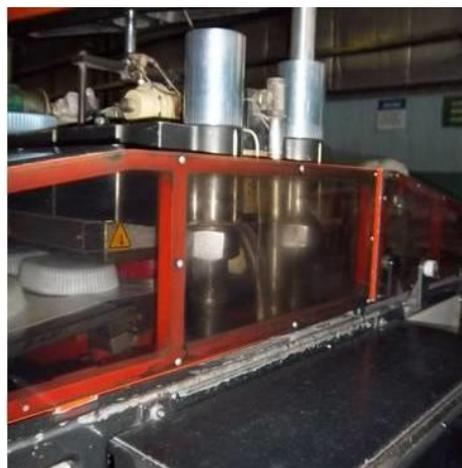
Figura 2-17: Protección para apilador
