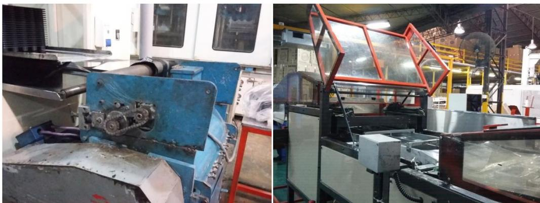
Figura 2-6 y 2-7 : Protecciones insuficientes y ausencia de micros de seguridad en termoformadoras
