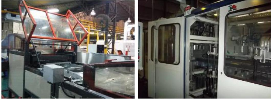
Figura 2-18: Protecciones de máquinas levantadas o abiertas por falta de micros de seguridad.
