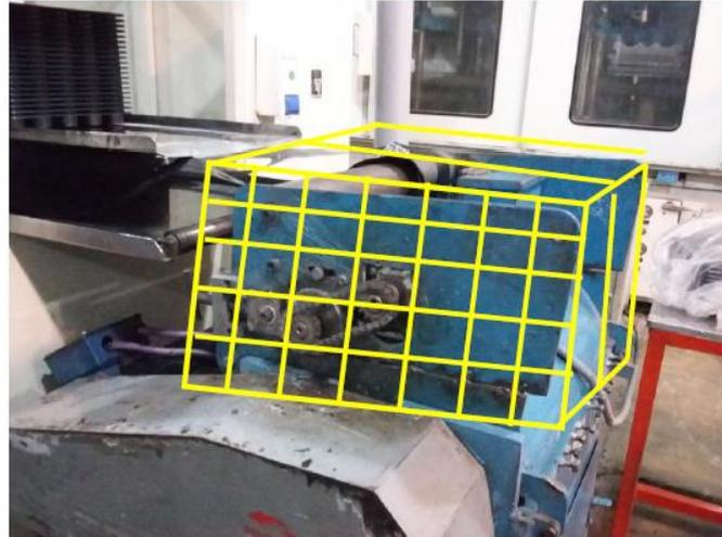
Figura 2-20: Protección para molino
