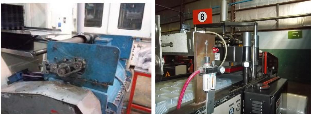
Figura 2-17: Falta de protecciones en partes móviles.
