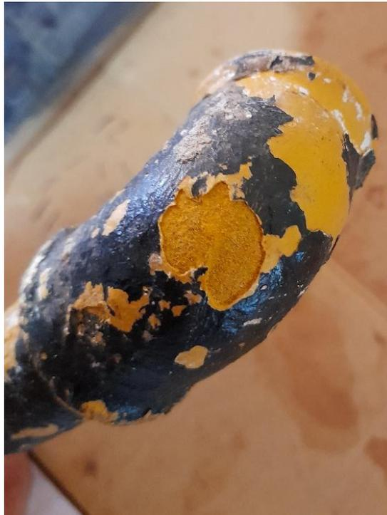
**Ilustración 40.** Desprendimiento de pintura en el caño tras los impactos. Fuente: elaboración propia.
